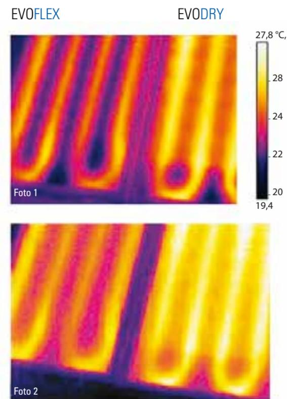
Raffronto di termografie tra un impianto radiante bugnato EVOFLEX Restauro e il sistema EVODRY. Si nota come il sistema bugnato abbia un'emissione termica a righe di calore, mentre il sistema EVODRY, grazie alla lamina in alluminio diffonde con maggior uniformità il calore.
